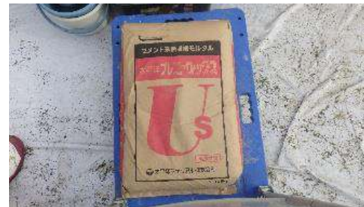
(図1-3) 無収縮モルタル (推奨品：太平洋プレユーロックスUHS)
